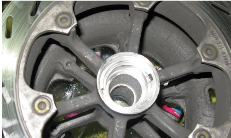
Pour le remontage, on sort les roulements du congélateur ou ils ont passé la nuit (les pauvres...) ce qui les a fait se rétracter un poil, et hop dans son logement. Je me suis servi de l'ancien roulement pour rentrer le neuf, et ensuite je me suis servi d'une douille de gros diamètre pour terminer de l'enfoncer. Attention de ne pas l'enfoncer de travers.
