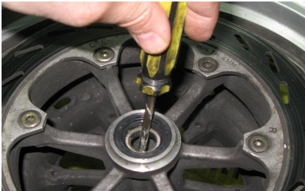
Il faut procéder de la même manière pour l'autre roulement et c'est plus facile car l'entretoise est sortie. Du coup on obtient une jante sans roulement, nettoyage des feuillures et diverses surface avec un dégraissant.
