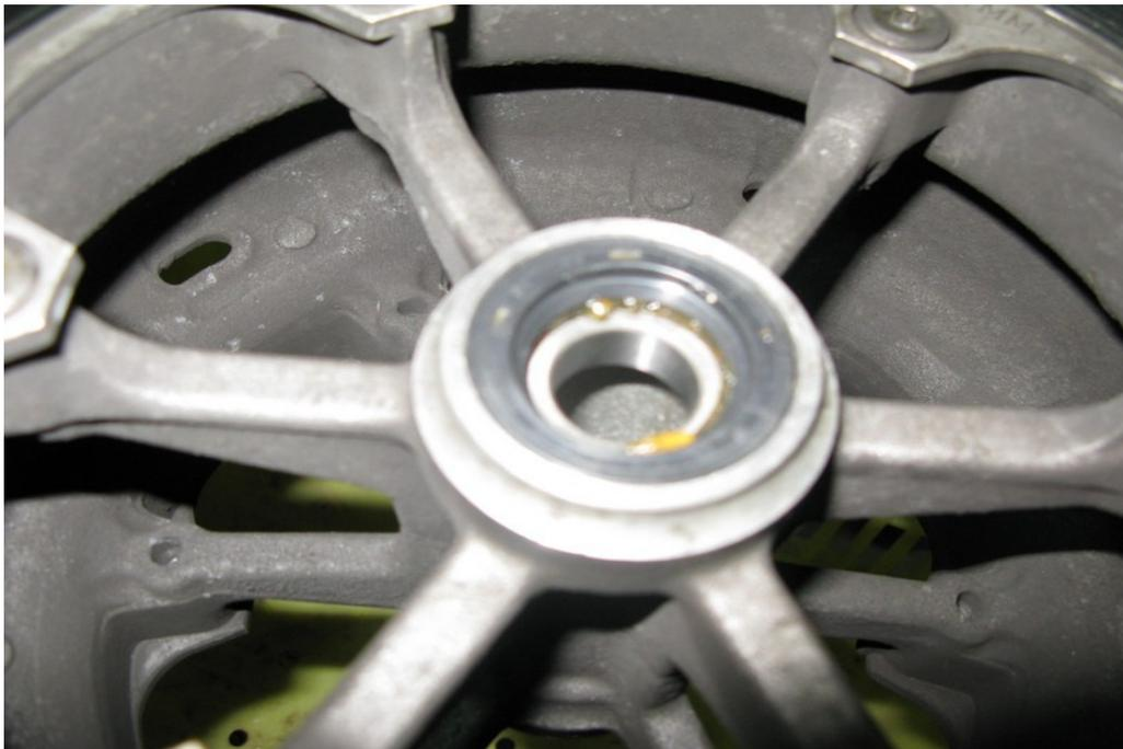
Ensuite remontage de la roue, **important, dégraissage des disques de frein**, remontages des étriers, du garde boue, on pompe un peu sur les frein et perception du cax et essai.....enfin s'il ne pleut pas, et chez moi ça tombe!
